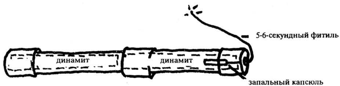
Рисунок 102. Удлиненный подрывной снаряд для разрушения крупных объектов.
